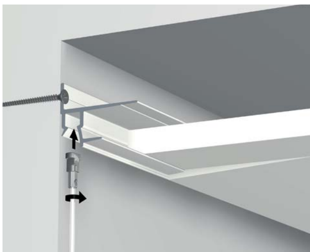
SHADOWLINE MASONRY (BEVESTIGING STENEN WAND)
